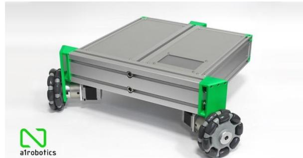
vigations- und Kartierungsalgorithmen. Durch die hohe Traglast von 50 kg ist das System auch für Aufbauten höheren Gewichts geeignet. Eine Besonderheit des Roboters ist sein omnidirektionaler Antrieb. Dadurch kann er sich aus dem Stand in jede beliebige Raumrichtung bewegen und Drehungen ausführen. Er bietet somit ein hochflexibles Antriebskonzept, das gut auch für komplex strukturierte Räume geeignet ist.
