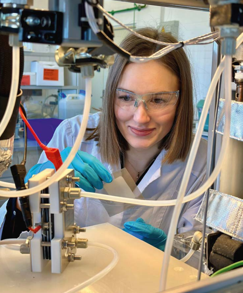
Lydia Weseler untersucht im Laborteststand Elektroden für die CO 2 -Elektrolyse.
