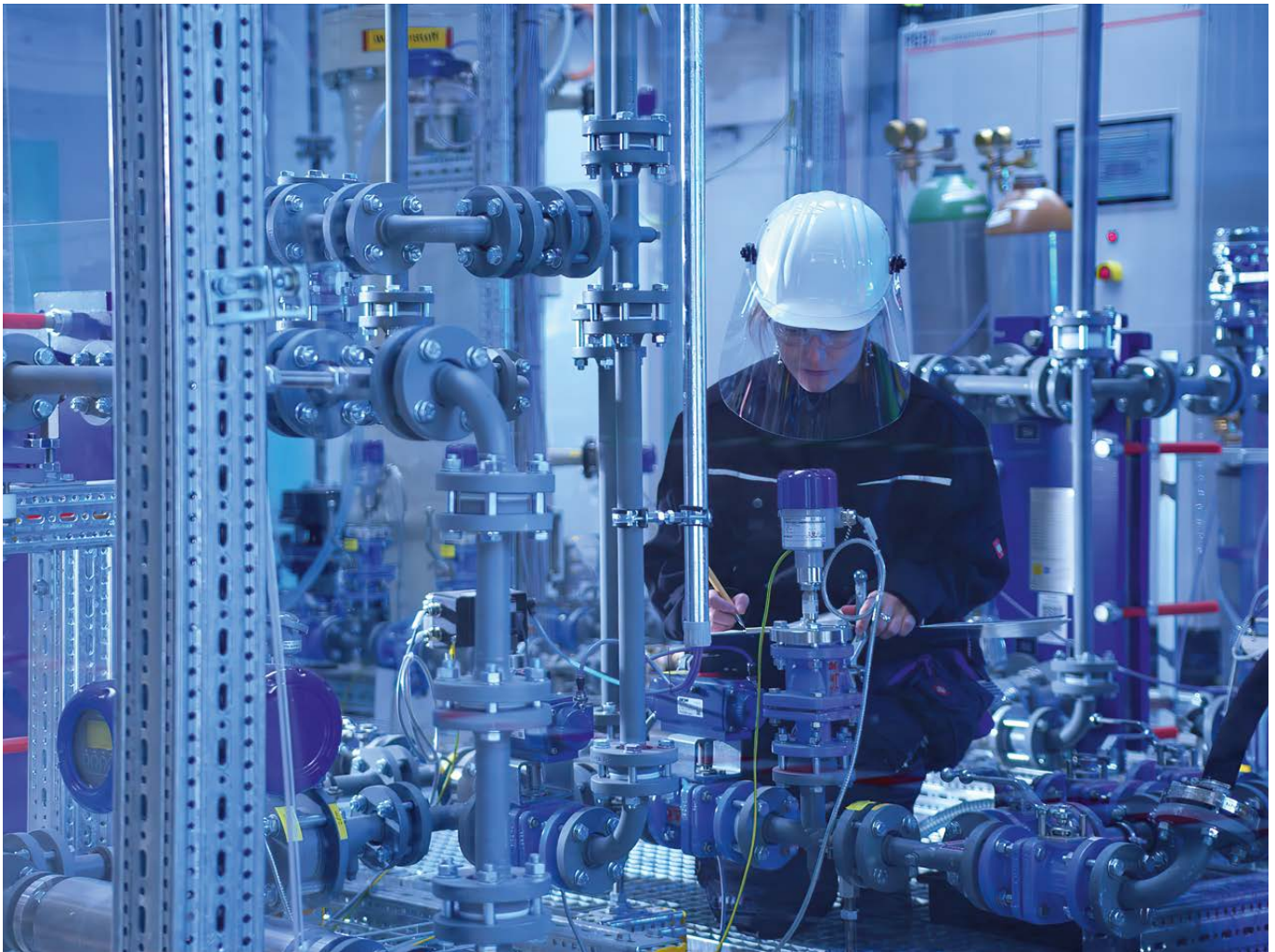
Stina Bauer nimmt Daten im Testfeld für die alkalische Wasserelektrolyse auf.
